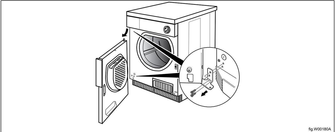
Déposer les vis du couvercle du côté opposé et les installer du côté où étaient situées les charnières. Installer les charnières du côté où étaient situées les vis du couvercle. Poser la charnière inférieure sans la serrer, avec une seule vis, afin de faciliter le positionnement de la porte.
