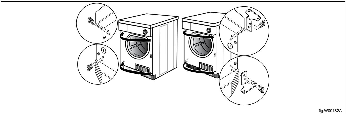
Déposer la poignée de la porte et reposer les vis. Poser la poignée de la porte du côté opposé à l'aide des vis existantes.
