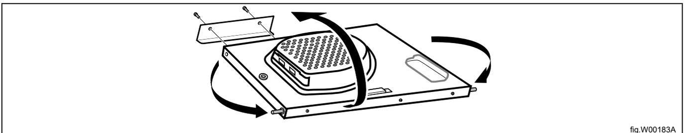
Déposer les panneaux de verrouillage en desserrant la barbelure à l'aide d'un tournevis.
